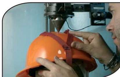
Resistência á Penetração
